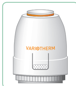
230 V AC elektrotermikus motor, áramkimaradásra zár, Előszőr-Nyit-Funkció, Clip rendszerű, felpattintható, üzemállapot jelzővel
